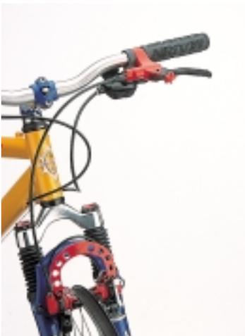
**6** So sieht die eine optimale **LEITUNGSFÜHRUNG** aus. Ein weicher Bogen führt knickfrei vom Bremsgriff zum Bremssattel. Vor der Fahrt dringend überprüfen, ob die Überwurfmutter am Bremssattel fest genug angezogen und damit dicht ist. Dazu im Stand die Bremse einige Male betätigen. Tritt Öl an der Verschraubung aus, fester zudrehen. Nicht vergessen, auch den Hebel am Lenker festzuziehen.
