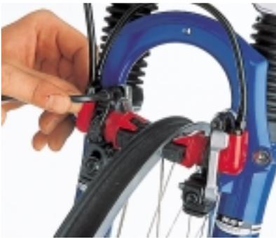
**3** Dank Vormontage ist der **BREMSSATTELANBAU** ein Kinderspiel: Sie müssen nur darauf achten, daß die silbernen Bremsmomentabstützungen (L-Stücke) an der Gabel anliegen. Dann die Klemmung der Bremszylinder lösen (5er Inbus) und diese in die richtige Position bringen. Die Bremsbeläge müssen mittig auf die Felgenflanke auftreffen.
