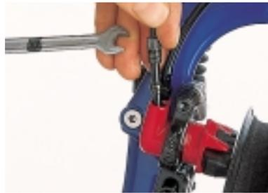
**4** Um die Leitungslänge anzupassen, muß man zuerst den Hebel (Geber) am Lenker montieren. Nun die **LEITUNG** an der Bremszange unten abschrauben, in einem weichen Bogen zum Bremszylinder herunterziehen und auf der richtigen Höhe mit den Fingern festhalten. Mit einem scharfen Messer oder Leitungsschneider, nicht mit einer Kneifzange, durchtrennen. Wichtig: Den oberen Teil stets gut festhalten, nicht wackeln, da sonst Öl austreten kann – und dann müssen Sie neu befüllen und entlüften.
