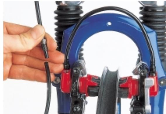
Nun die Überwurfmutter und die dichtende **ALUHÜLSE** (die neuen schwarzen sind übrigens symmetrisch) über die Leitung schieben. Vorsichtig in die Bremszange einführen und die Überwurfmutter mit Gefühl anziehen. Nicht übertreiben, hier reichen 4 Nm.
