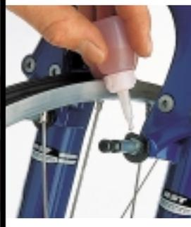
**2** Je nach Gabel werden verschiedene **DISTANZSCHEIBEN** verwendet. An Federgabeln die breiteren Aluringe (ganz links) montieren und mit dem Inbus sichern. An Starrgabeln die Stahlringe mit Schraubensicherung auf die Sockel kleben. In Fahrtrichtung links wird die Schnellspannerschraube eingedreht.
